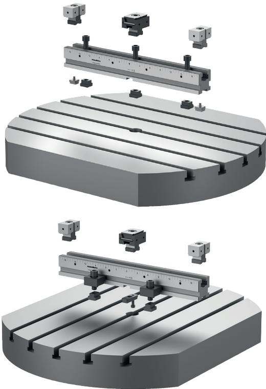
Montage des Mehrfach-Spannsystems in Längs- und Querrichtung auf T-Nutenmaschinentischen möglich. Ausrichtung mit Nutensteinen. Befestigung mit Befestigungsschrauben oder Spannpratzen.
